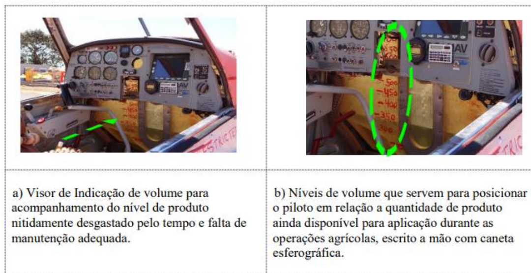
Figura 2 - Foto do interior da cabine de uma aeronave agrícola, modelo Ipanema, destaque para estado de conservação da aeronave em especial para o visor de volume de produto (improvisado com escrita a caneta)
