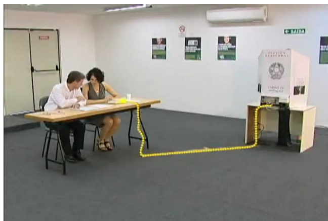
1:45 min – destacando, em amarelo, a conexão do Terminal do Mesário com o Terminal do Eleitor em urnas comuns
